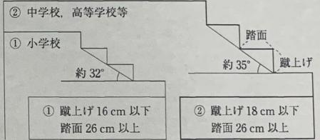
階段の傾斜をちょうど  $33^\circ$  とするとき, 踏上げを 18 cm 以下にするには, 踏面をどのような範囲に設定すればよいか。踏面を  $x$  cm として,  $x$  のとり得る値の範囲を求めるための不等式を,  $33^\circ$  の三角比と  $x$  を用いて表せ。解答は, 解答欄 [い] に記述せよ。ただし, 踏面と踏上げの長さはそれぞれ一定であるとし, また, 踏面は水平であり, 踏上げは踏面に対して垂直であるとする。
